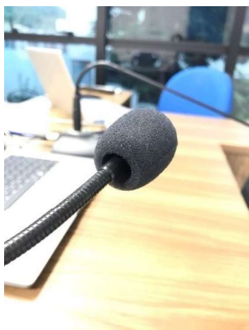
Figura 5 - Espuma com folga e não adequada ao tipo de microfone
