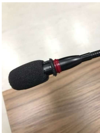
Figura 4 - Espuma com desgaste e rasgo
