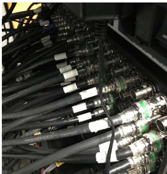
Figura 2 - Exemplo de uso: painel traseiro do equipamento Blackmagic Videohub 40x40.
