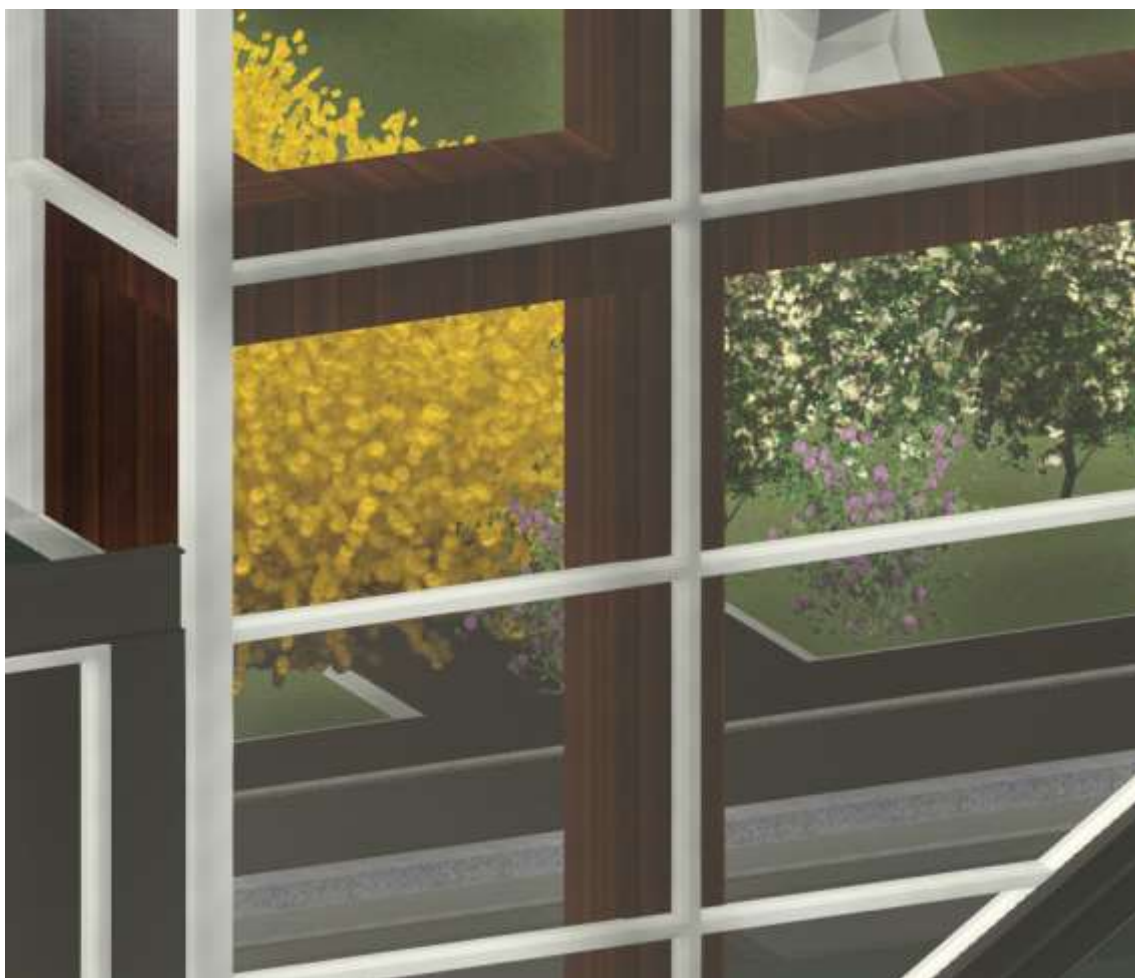
Pilares pré-moldados internos revestidos de madeira.
