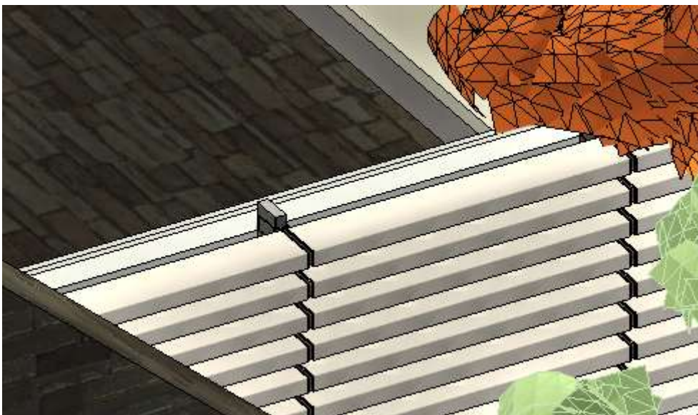
Detalhe mostrando os brises e estruturas de fixação internas.
