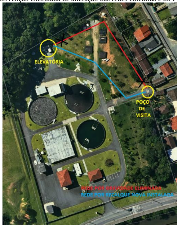
Imagem 09: PV aberto sendo transformado em uma nova elevatória - ETE São Luis
