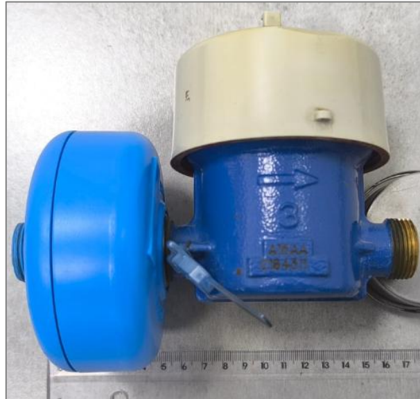
Figura 3 – Exemplo de montagem de conjunto filtro externo.e hidrometro volumétrico.
