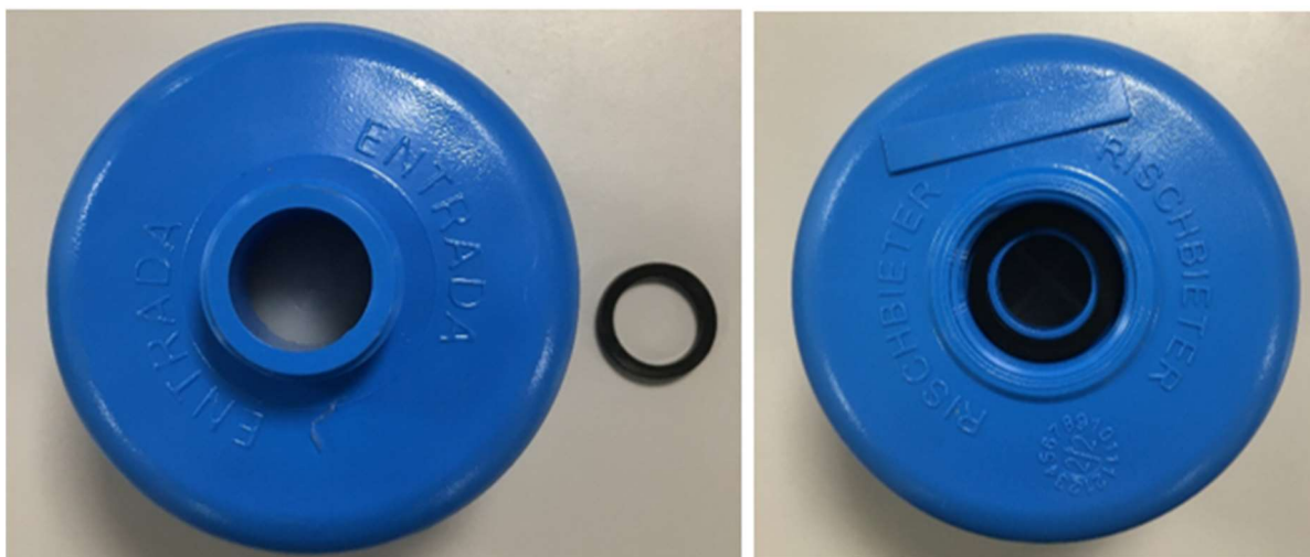
Figura 06: Entrada e saída do retentor
