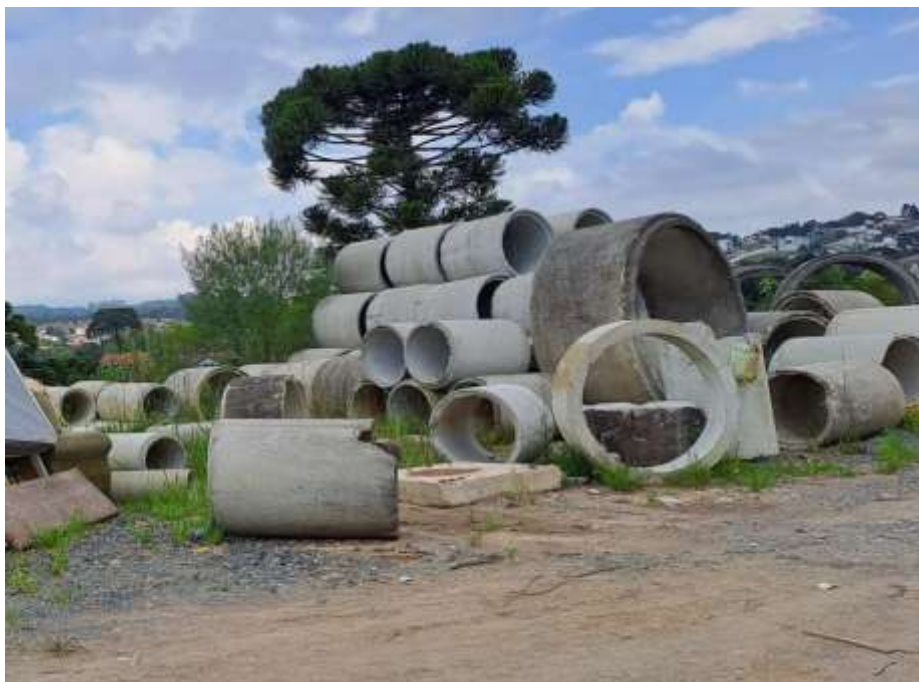
Imagem 02 – Manilhas de concreto
