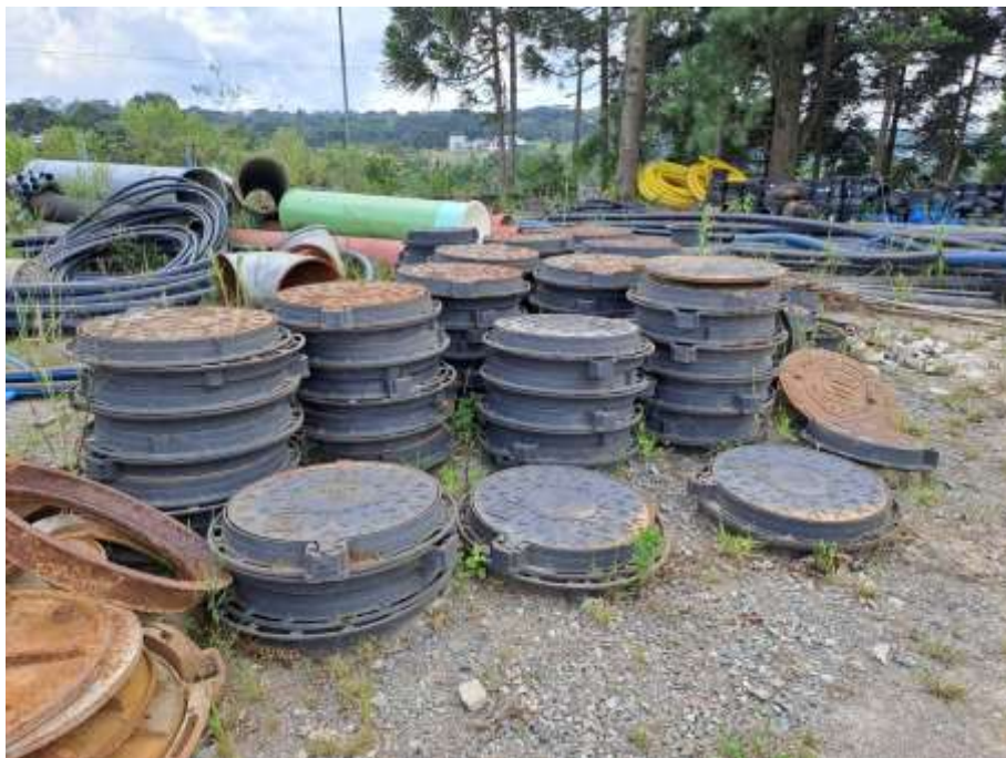
Imagem 03 – Tampas de poço de visita
