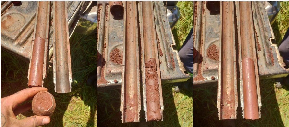
Figura 9: Material encontrado no amostrador durante a realização da sondagem SPT 07.
