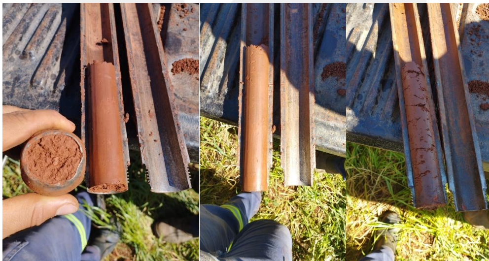
Figura 4: Material encontrado no amostrador durante a realização da sondagem SPT 02.
