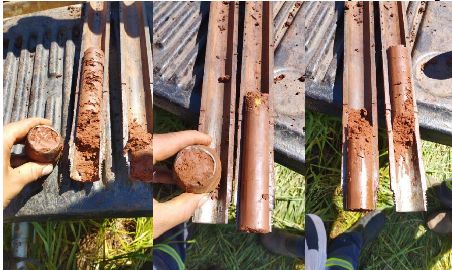
Figura 5: Material encontrado no amostrador durante a realização da sondagem SPT 03.
