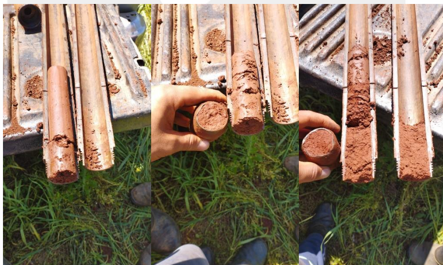
Figura 7: Material encontrado no amostrador durante a realização da sondagem SPT 05.
