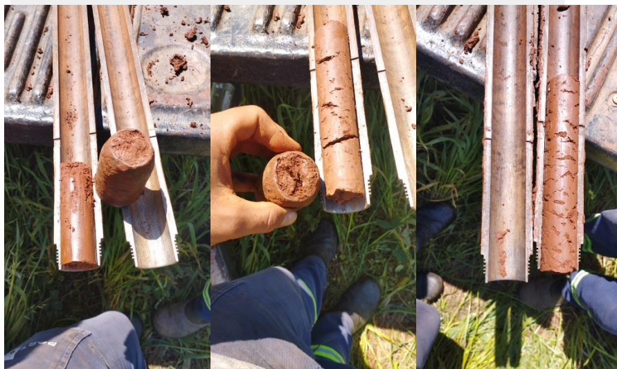
Figura 7: Material encontrado no amostrador durante a realização da sondagem SPT 05.
