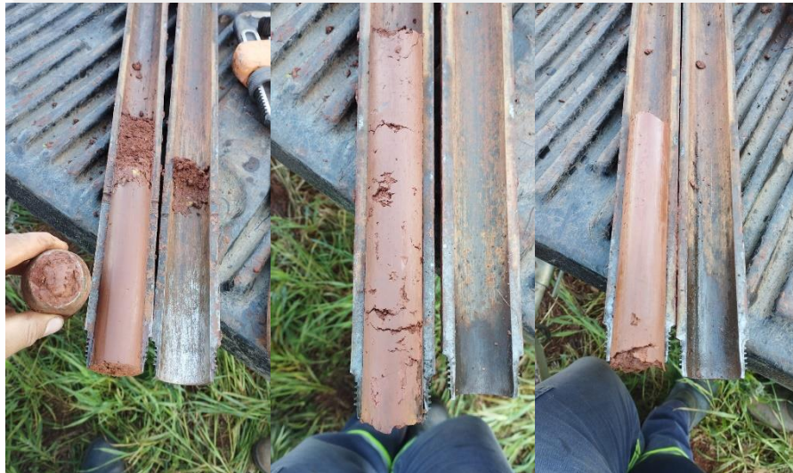
Figura 3: Material encontrado no amostrador durante a realização da sondagem SPT 01.
