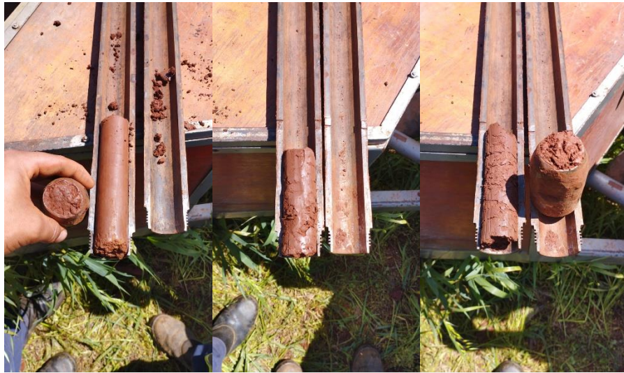
Figura 8: Material encontrado no amostrador durante a realização da sondagem SPT 06.
