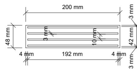
CORTE 05 - APARELHO DE APOIO 1:5
