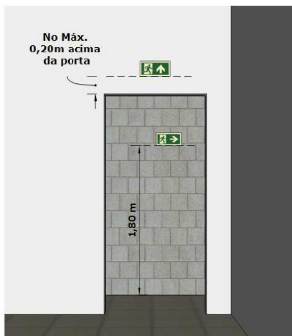
Figura 13: Sinalização do sentido de rota de fuga.
