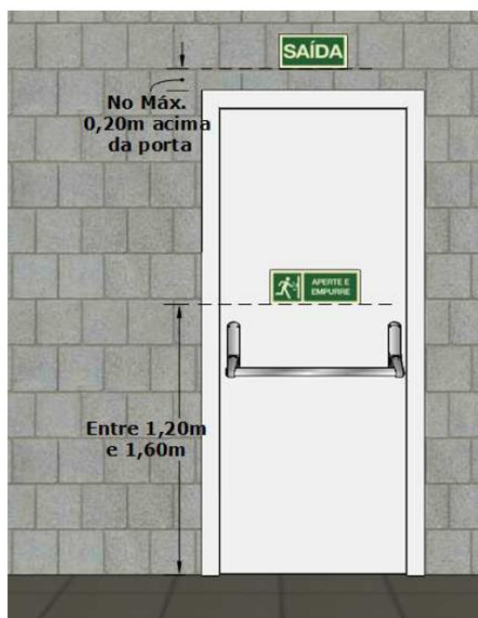
Figura 14: Sinalização de porta de saída de emergência e sinalização de abertura da porta por barra antipânico.
