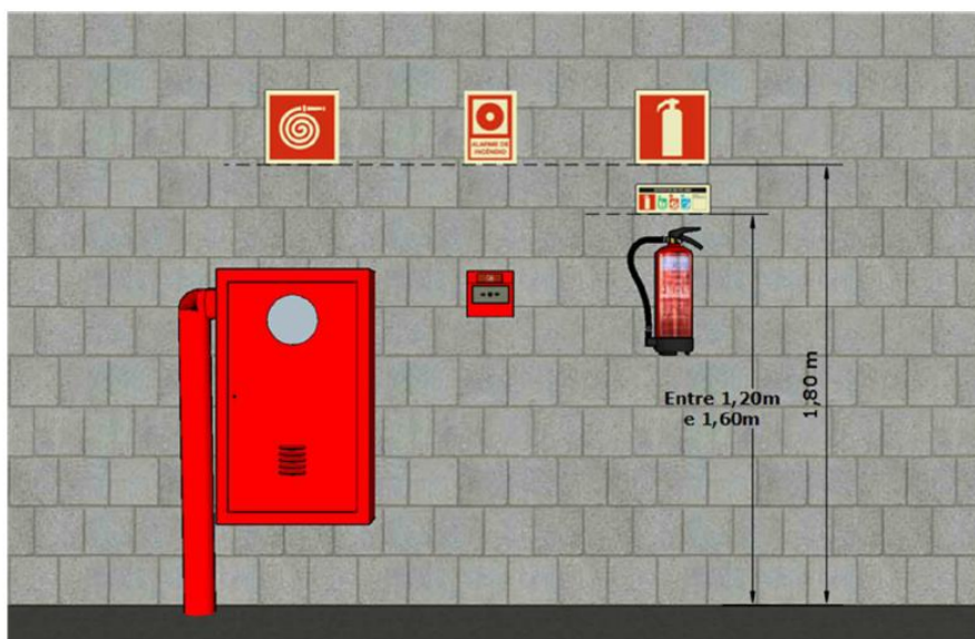
Figura 12: Sinalização básica de equipamentos.
