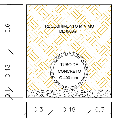
Detalhe escavação e reaterro de tubos
