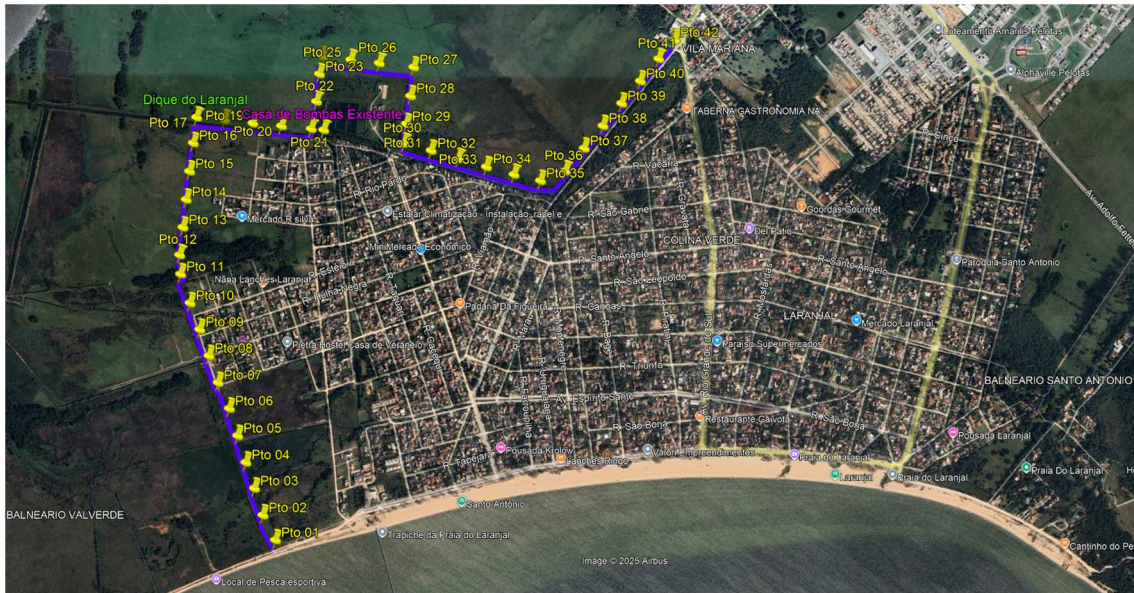
Figura 2: Localização dos Pontos para Sondagem – Ampliação do Dique de Contenção
