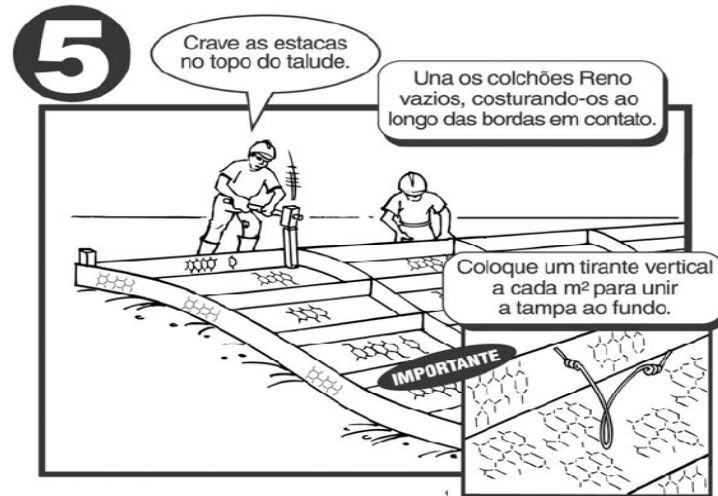
Fig. 18 – União das peças e tirante
