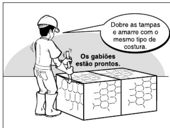
Fig.14 - Detalhe da etapa de fechamento do gabião tipo caixa
