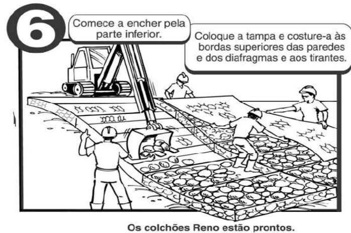
Fig. 19 Enchimento e fechamento dos Colchões.
