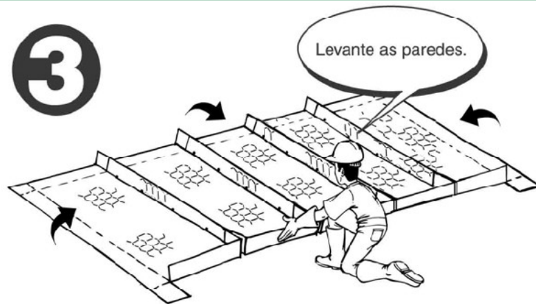
Fig. 16 – Montagem do colchão
