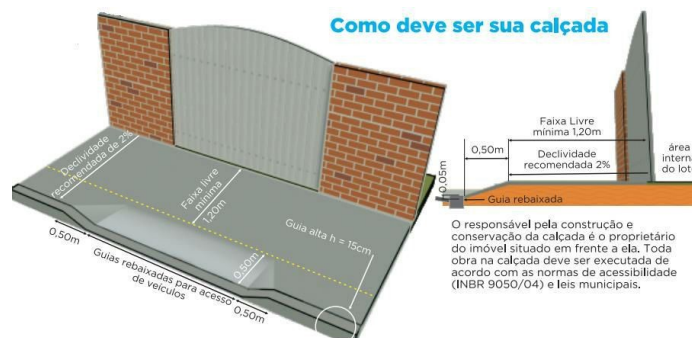
Figura: Rebaixo de meio-fio em acesso veicular.
