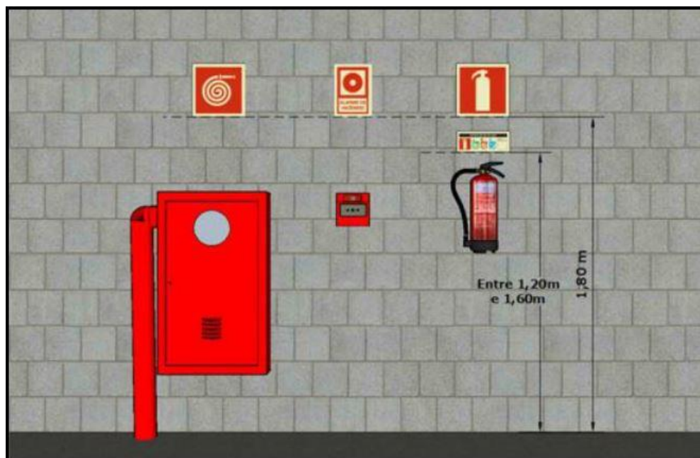
Figura 01 – Sinalização de Equipamentos.
