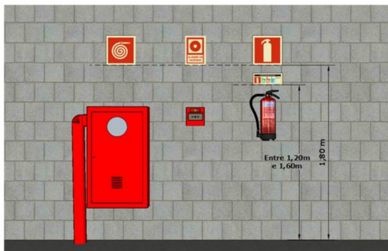
Imagem 01 – Sinalização básica de equipamentos (ver sinalizações de códigos E1 a E19 e N1 a N5)
