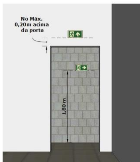
Imagem 02 – Sinalização do sentido da rota de fuga. Em primeiro plano, sinalização de vão de abertura sem a folha da porta. (ver sinalizações de códigos S1 a S15-E)
