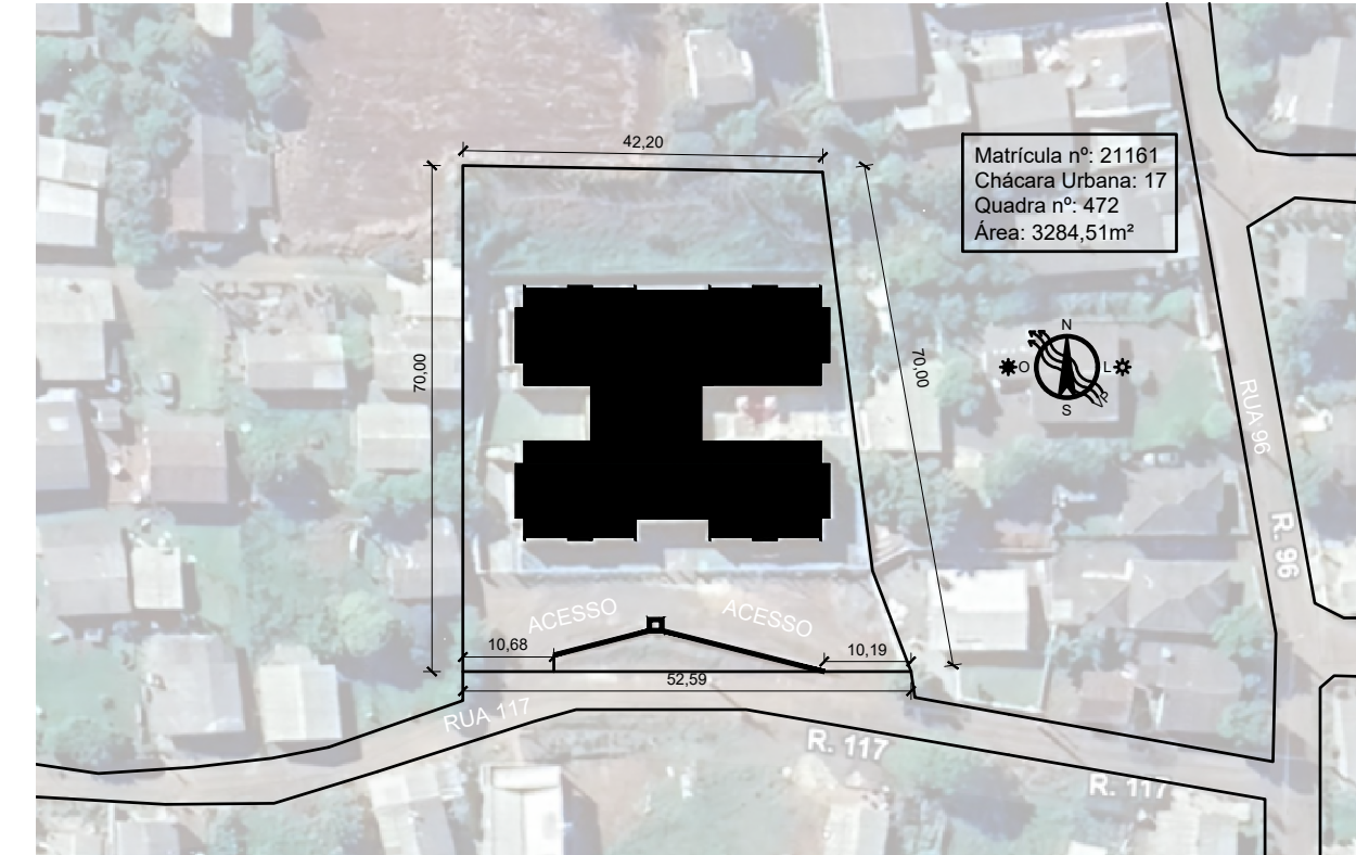
1 PLANTA DE SITUAÇÃO E LOCALIZAÇÃO ESCALA 1/750
