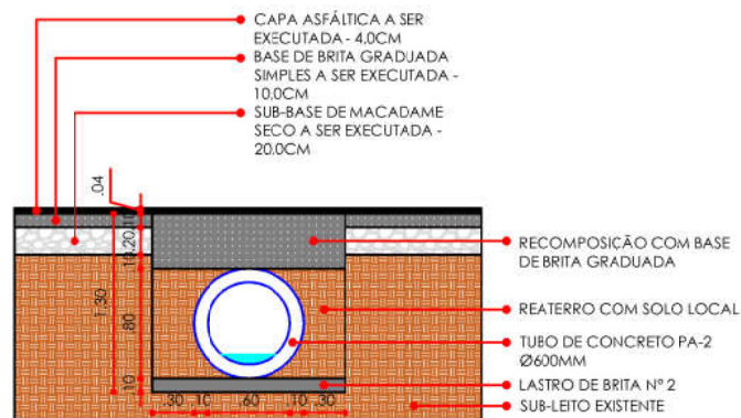
SEÇÃO TRANSVERSAL TUBULAÇÃO Ø600MM esc 1/25
