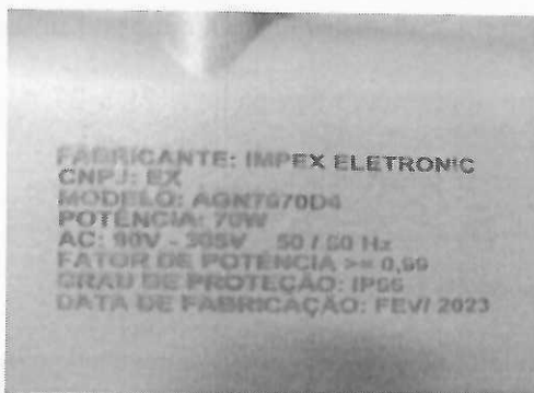
Figura 2: identificação, gravação a laser, no corpo da luminária
