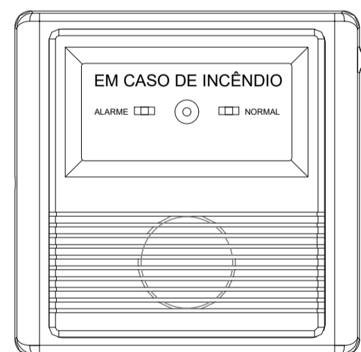
DETALHE ACIONADOR E SONORIZADOR ALARME SEM ESCALA
