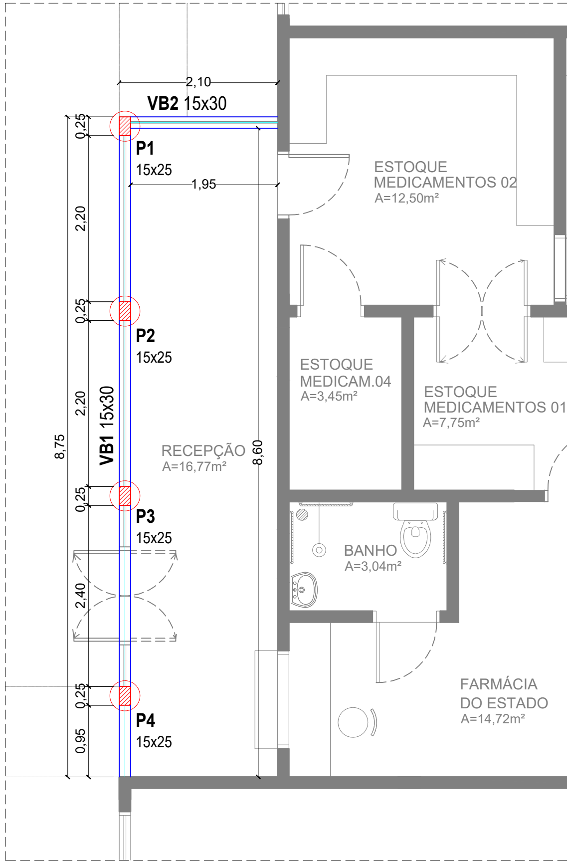
PLANTA BAIXA ESTRUTURAL - BALDRAME ESCALA: 1/50
