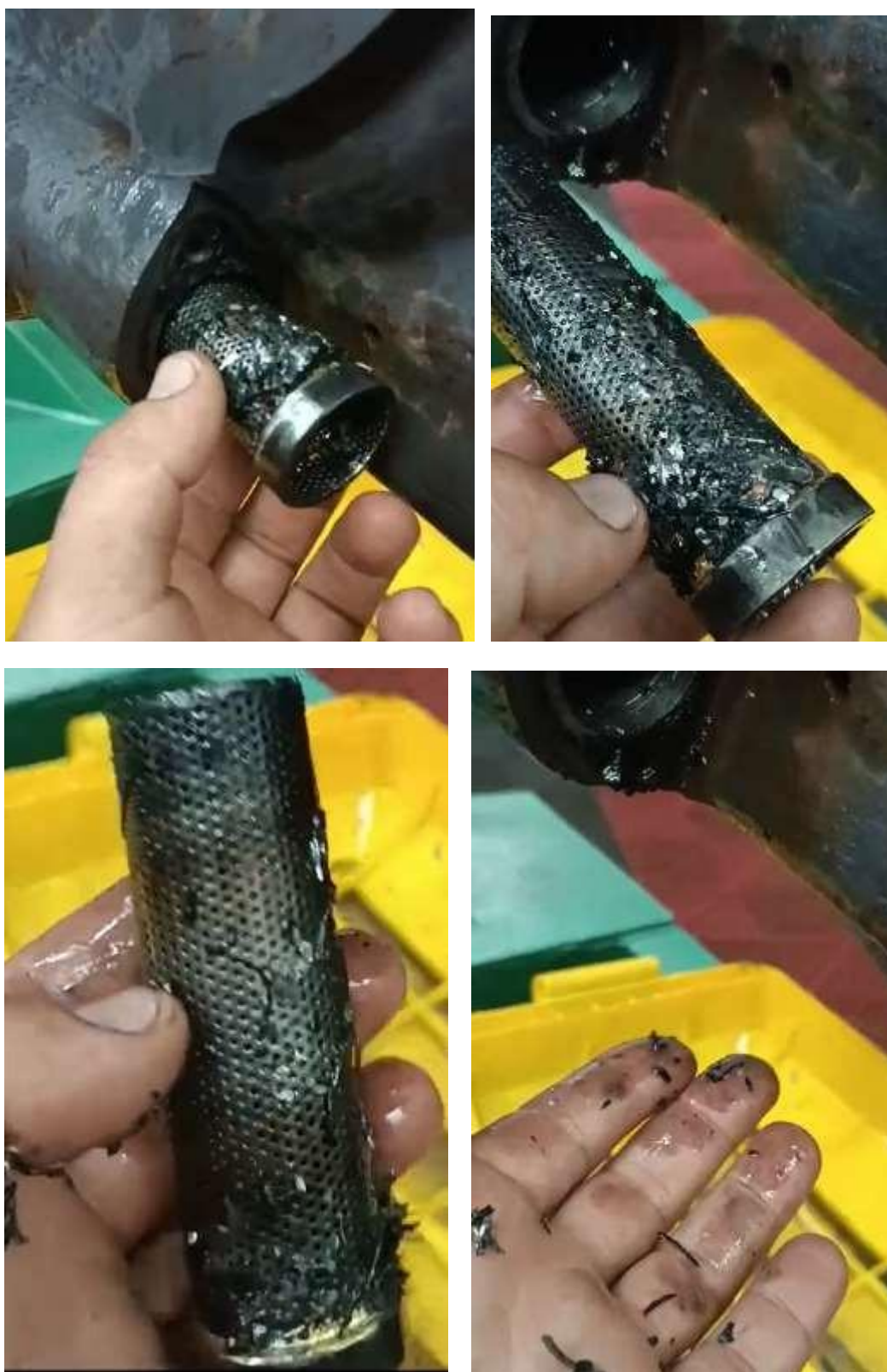
Figura 6 – Filtro da transmissão apresentando limalhas de ferro
