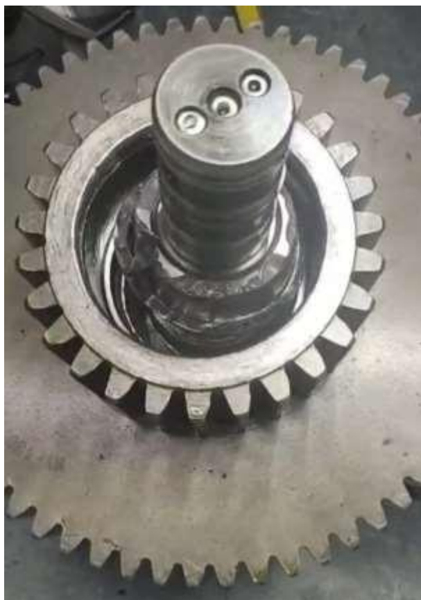
Figura 5 – Fratura e desgaste nos dentes das engrenagens e eixos
