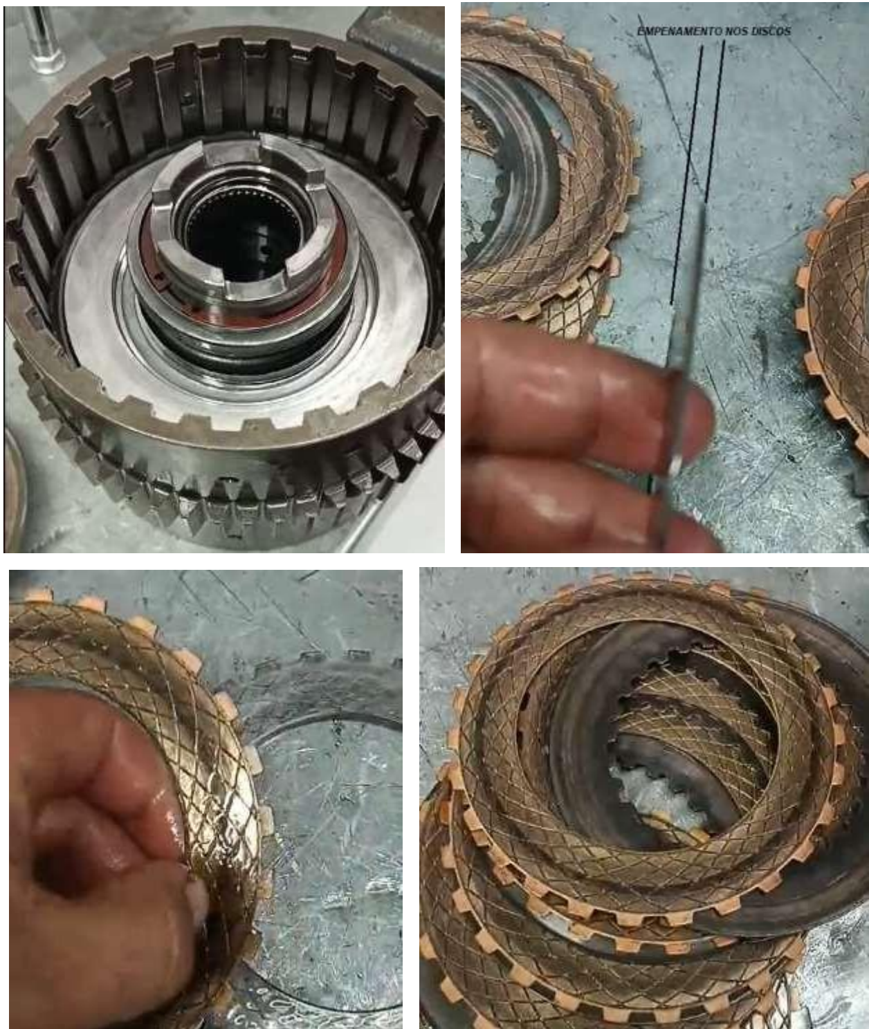
Figura 4 – Discos separadores da transmissão danificados
