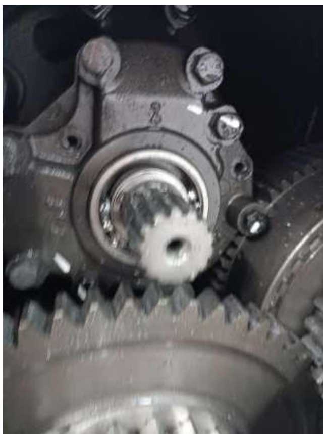
Figura 5 – Fratura e desgaste nos dentes das engrenagens e eixos
