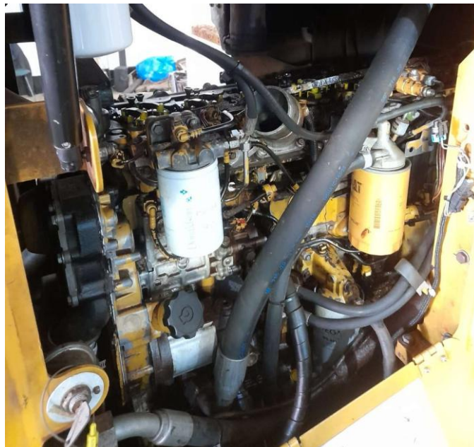
Figura 3 – Motor em avaliação com sistema de injeção desmontado
