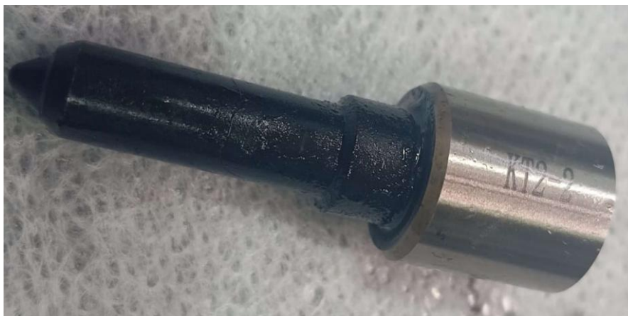
Figura 6 – Ponteiros do eletroinjeter apresentando deformação mecânica e obstrução
