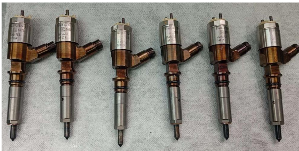
Figura 4 – Bicos injetores do motor retirados e encaminhados para teste em bancada
