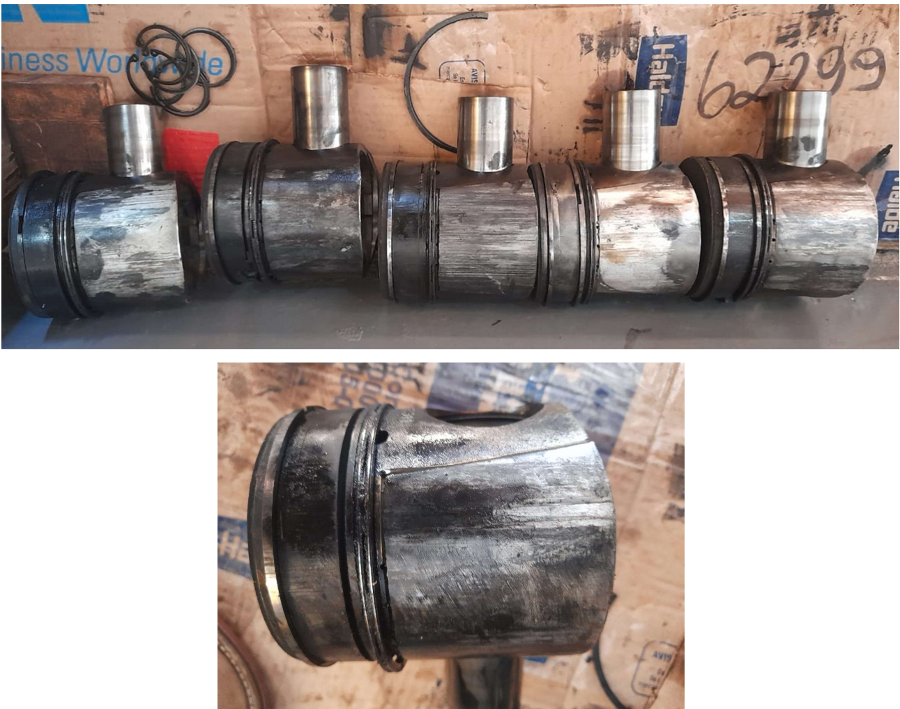
Figura 6 – Pistões com alto nível de carbonização, anéis, camisas e bronzinas danificados
