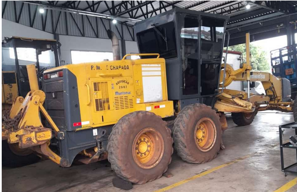
Figura 1 – Motoniveladora GD555 inspecionada
