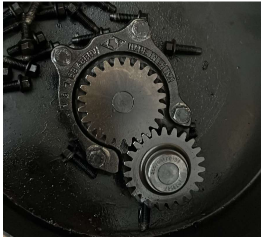
Figura 9 – Substituir bomba de óleo
