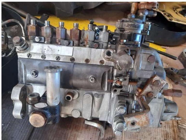
Figura 12 – Recondicionar bomba injetora e bicos de injeção de combustível
