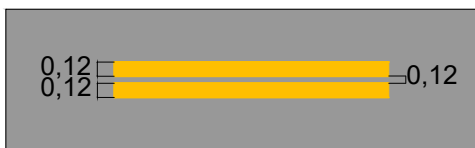
Detalhe da Pintura Contínua do Eixo da Pista (LFO-03)
