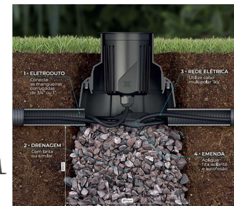
DETALHE DE INSTALAÇÃO LUMINÁRIA FOCAL EMBUTIDA NO SOLO - sem escala
