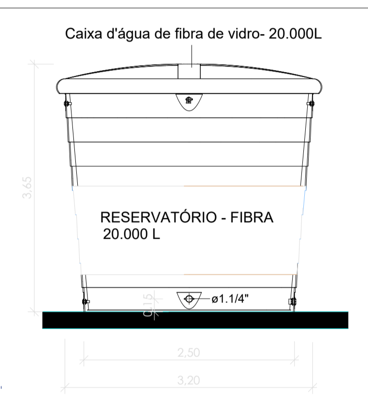
DETALHE: RESERVATÓRIO ESCALA: N/A
