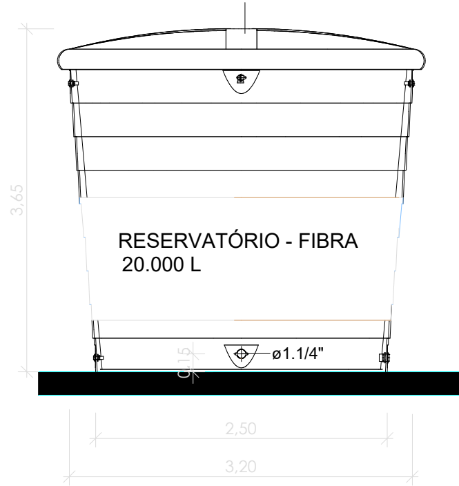
DETALHE - RESERVATÓRIO ESCALA: N/A
