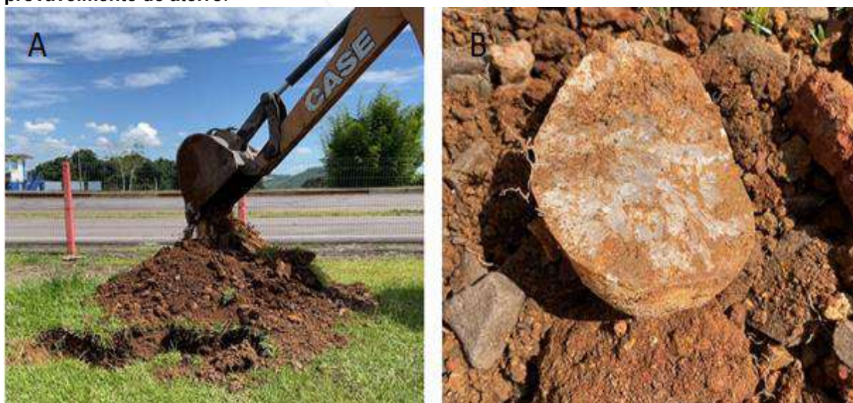
Figura 3 – Em A e B, fragmentos de rocha em subsuperfície encontrados na Sondagem S3 e S4, provavelmente de aterro.
