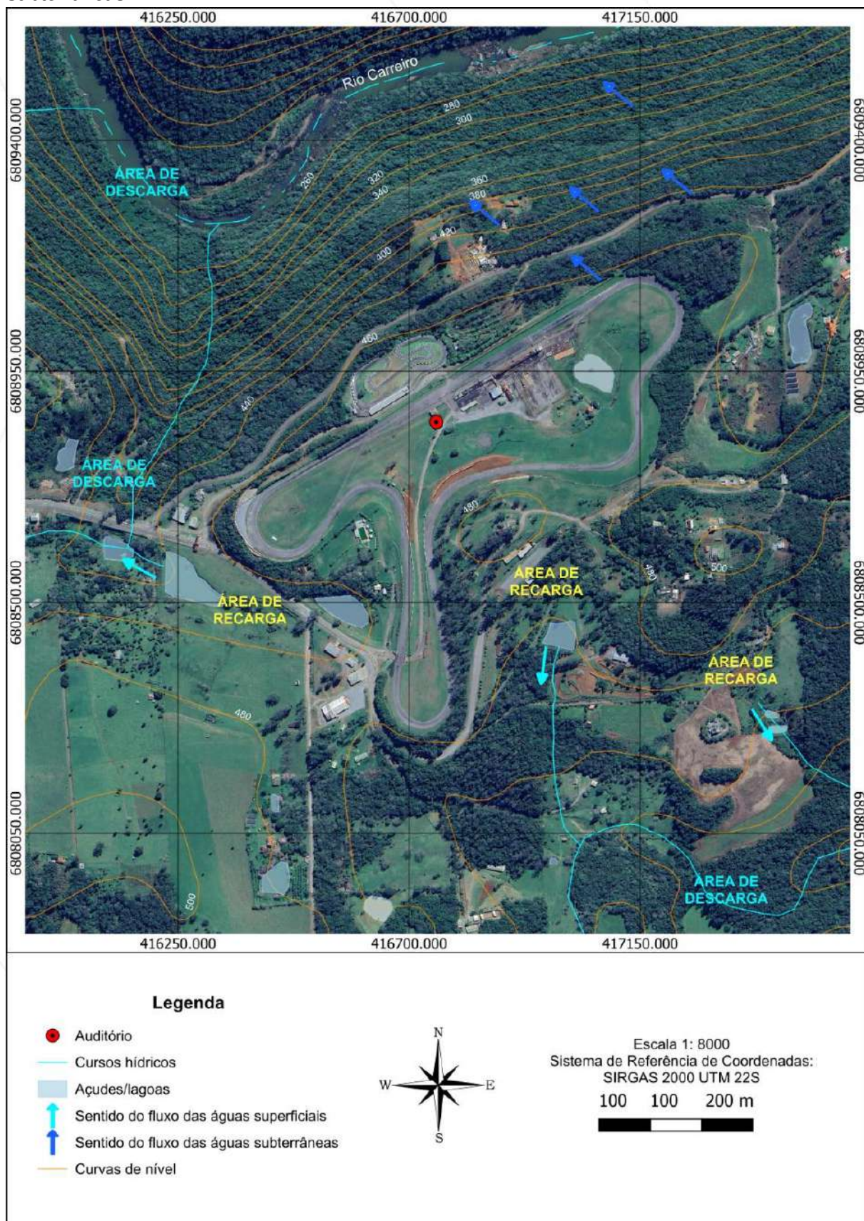
Figura 7 - Mapa de localização de cursos/corpos hídricos próximos à área do empreendimento com indicação do sentido de fluxo das águas superficiais e provável sentido de fluxo das águas subterrâneas
