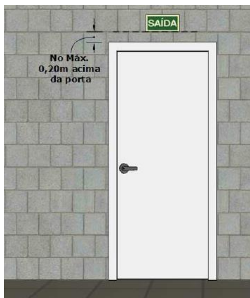
Figura 09 – Instalação da sinalização de saída de emergência
