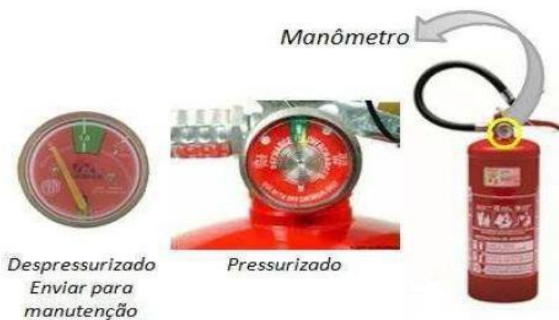
Figura 06 - Indicação de pressurização dos extintores
