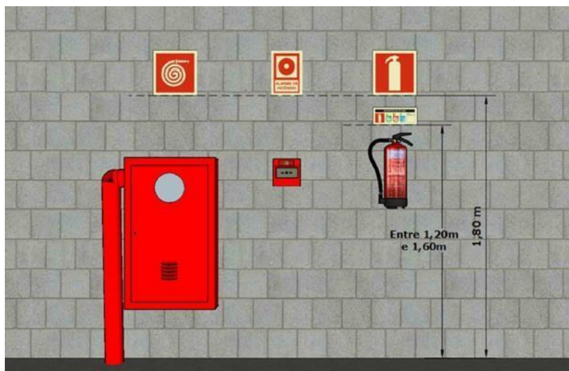
Figura 08 – Instalação de sinalização básica de equipamentos
