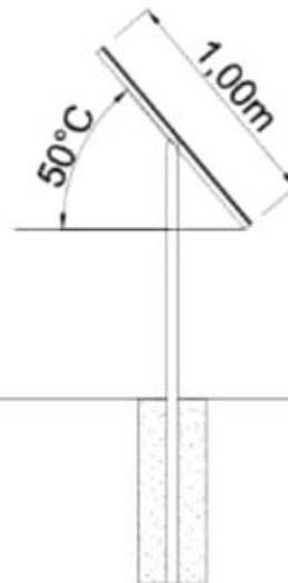
DETALHAMENTO LATERAL (inclinação de 50° referente ao solo)
