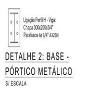
DETALHE 2: BASE - PÓRTICO METÁLICO
