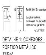
DETALHE 1: CONEXÕES - PÓRTICO METÁLICO
