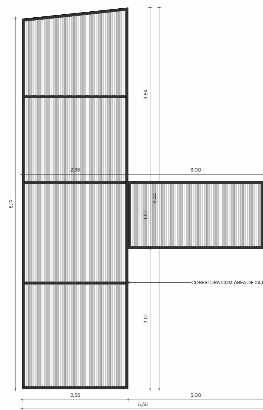
03 DET. COBERTURA METÁLICA Escala: 1 : 50
