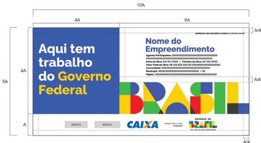
Figura 3 - Layout Placa de obra
