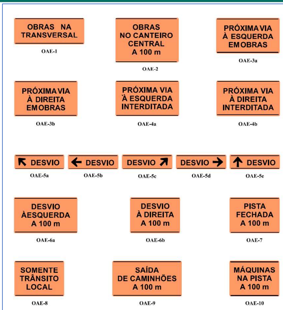
Figura 2 - Modelos placas de sinalização de obras
