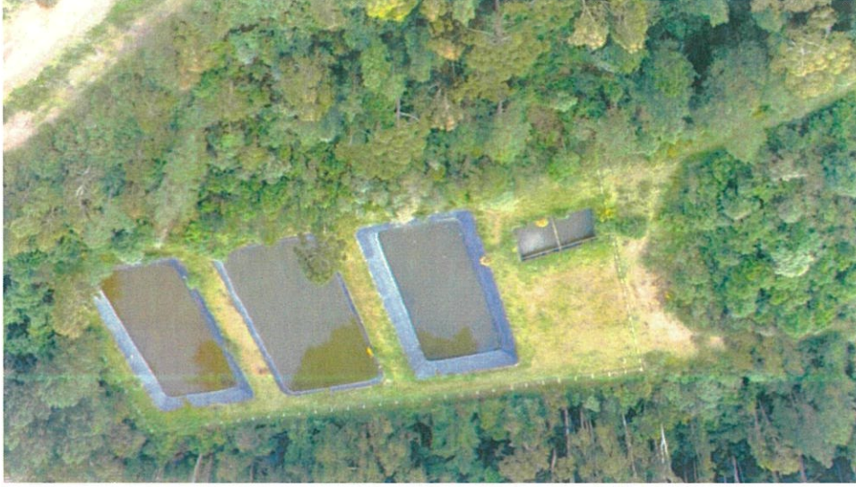
Foto 2. Vista da bacia de acúmulo (menor) e das três lagoas de estabilização (novembro, 2021).
