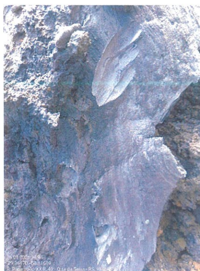
Figura 7. Solo argiloso acinzentado, plástico, úmido.
