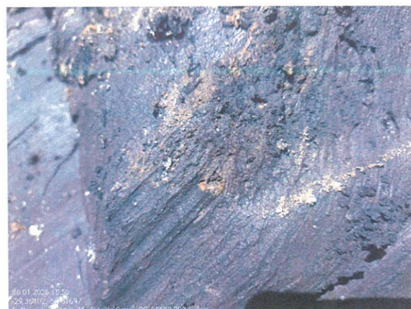
Figura 11. Solo argilosa, de coloração preta, plástica, bem coeso, úmido.
