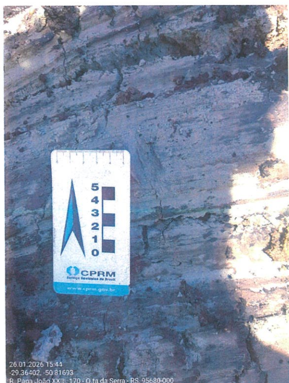
Figura 10. Solo argiloso acinzentado, plástica, úmido.
