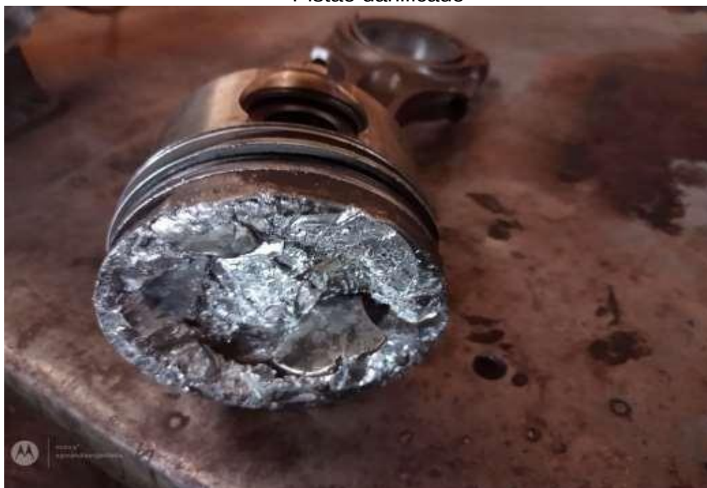
Pistão onde ocorreu a quebra da válvula
