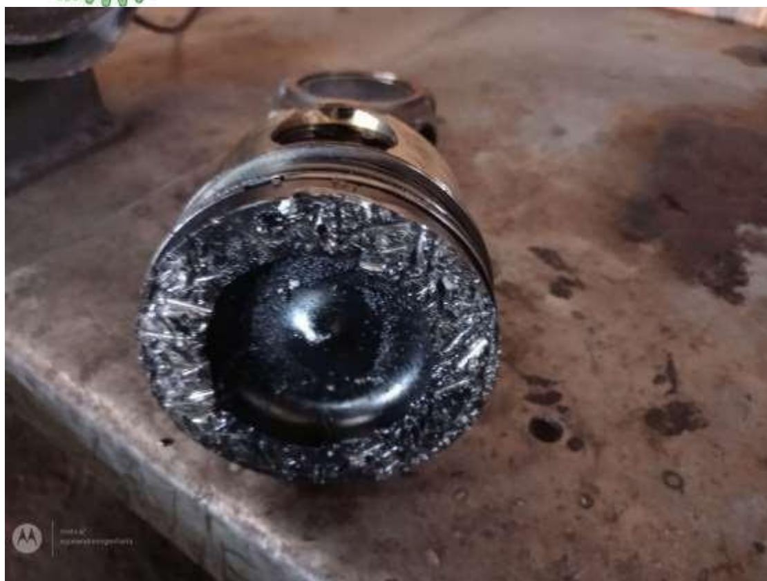
Pistão ao lado de onde ocorreu a quebra da válvula
