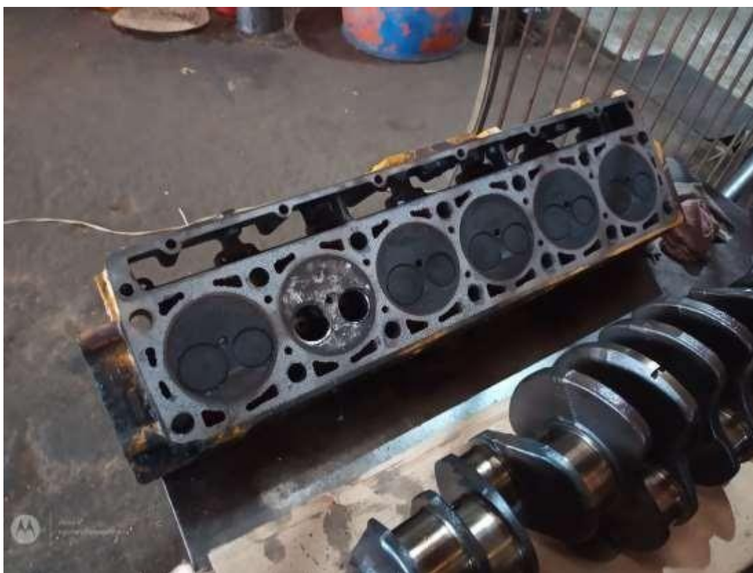
Tampa de válvulas onde ocorreu a quebra
