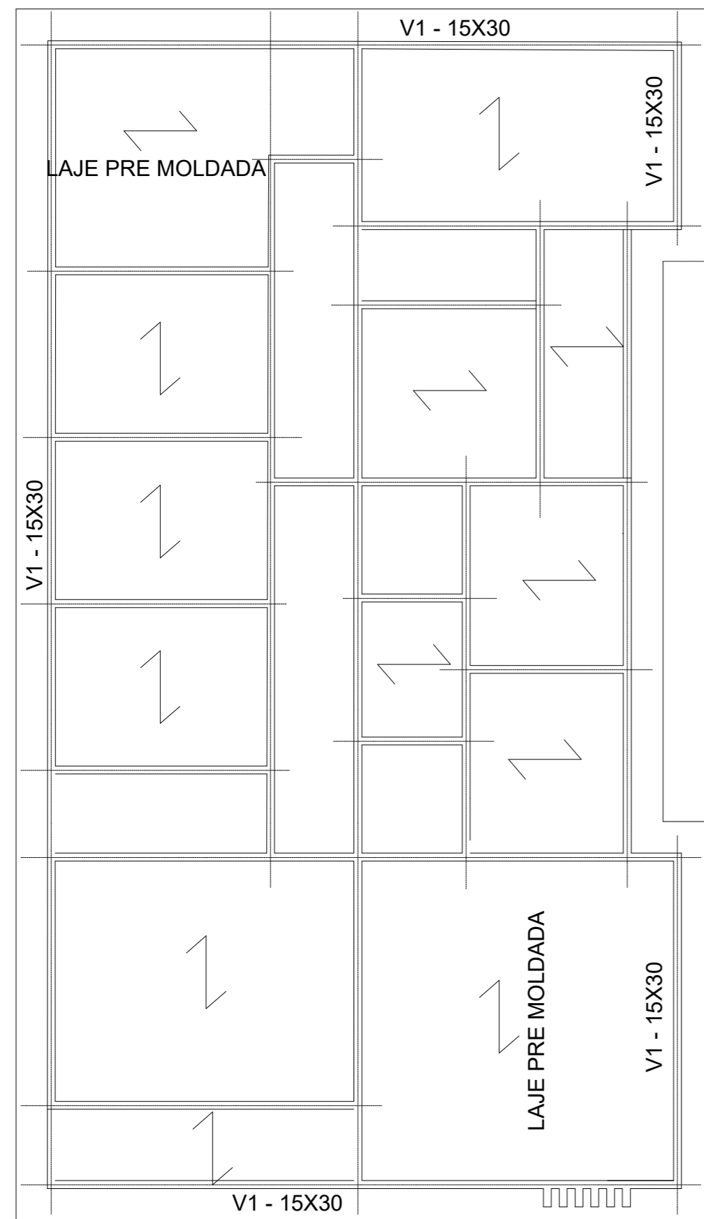
PLANTA BAIXA- PROJETO VIGA SUPERIOR E LAJE
