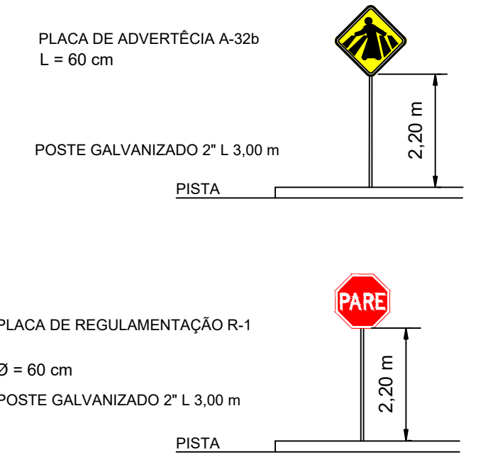
05 Detalhe de Placas de Sinalização S/Escala
