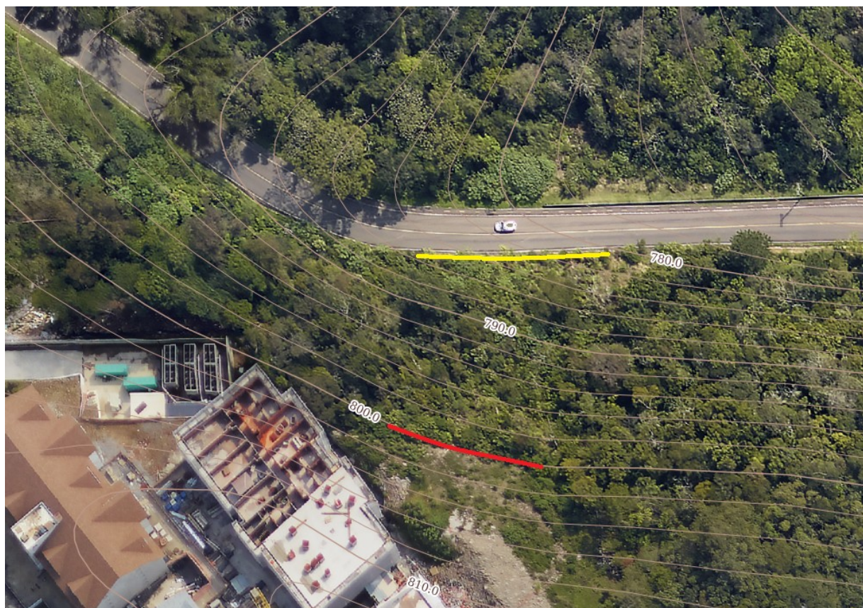
Figura 1 – Feições do terreno com posição aproximada da ruptura da crista do talude em vermelho, posição do pé da ruptura, em amarelo. Adaptado de http://sig.gramado.rs.gov.br .
