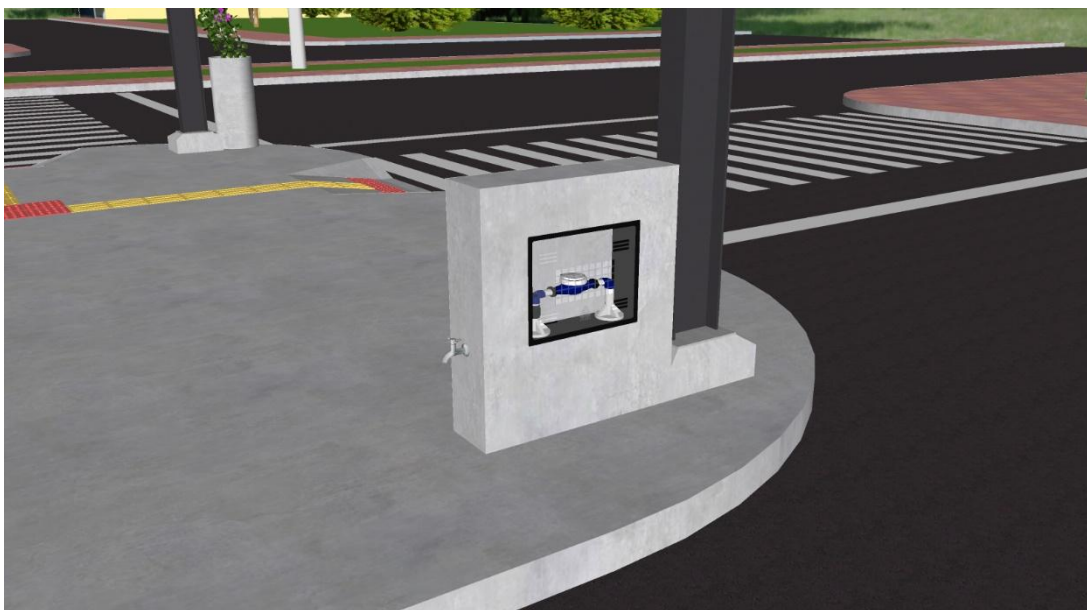
Figura 5 - Mureta Concessionária e Torneira de Jardim
