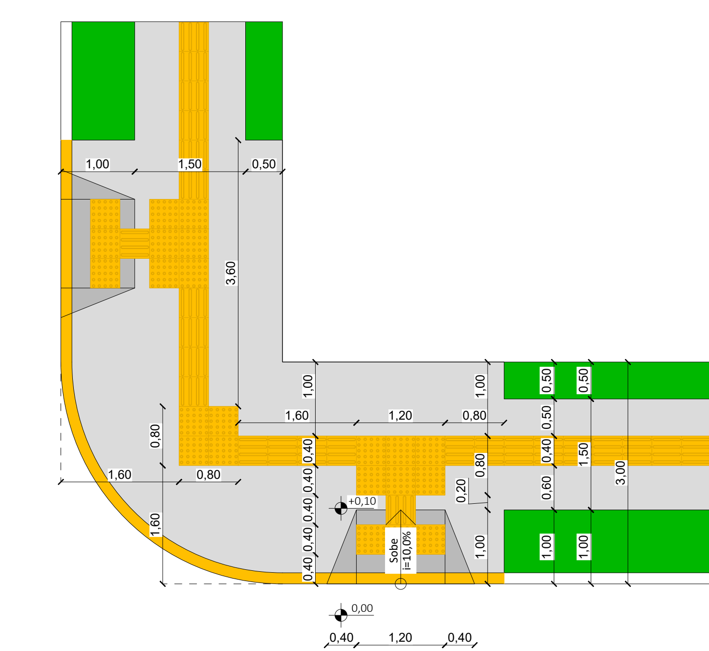
REBAIXO DE CALÇADAS ESQUINAS ESCALA 1:50
