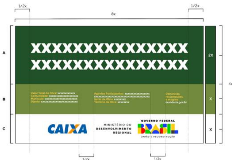
Figura 2: Placa de obra
