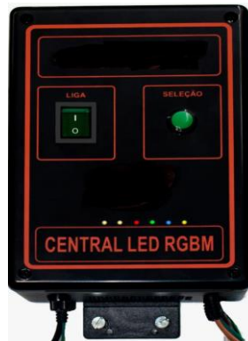
Figura 02 – Central RGB com fonte 12V integrada.
