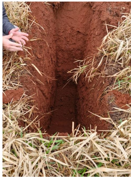
Figura 3 - Vista geral, sem presença de rochas, c lençol freático, presença predominante de argila
