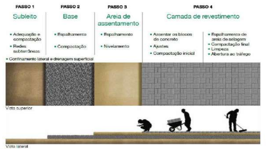
Figura: Etapas do piso intertravado de concreto.
