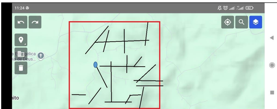
Figura 8- Locação de poço (círculo azul) em imagem com lineamentos.
