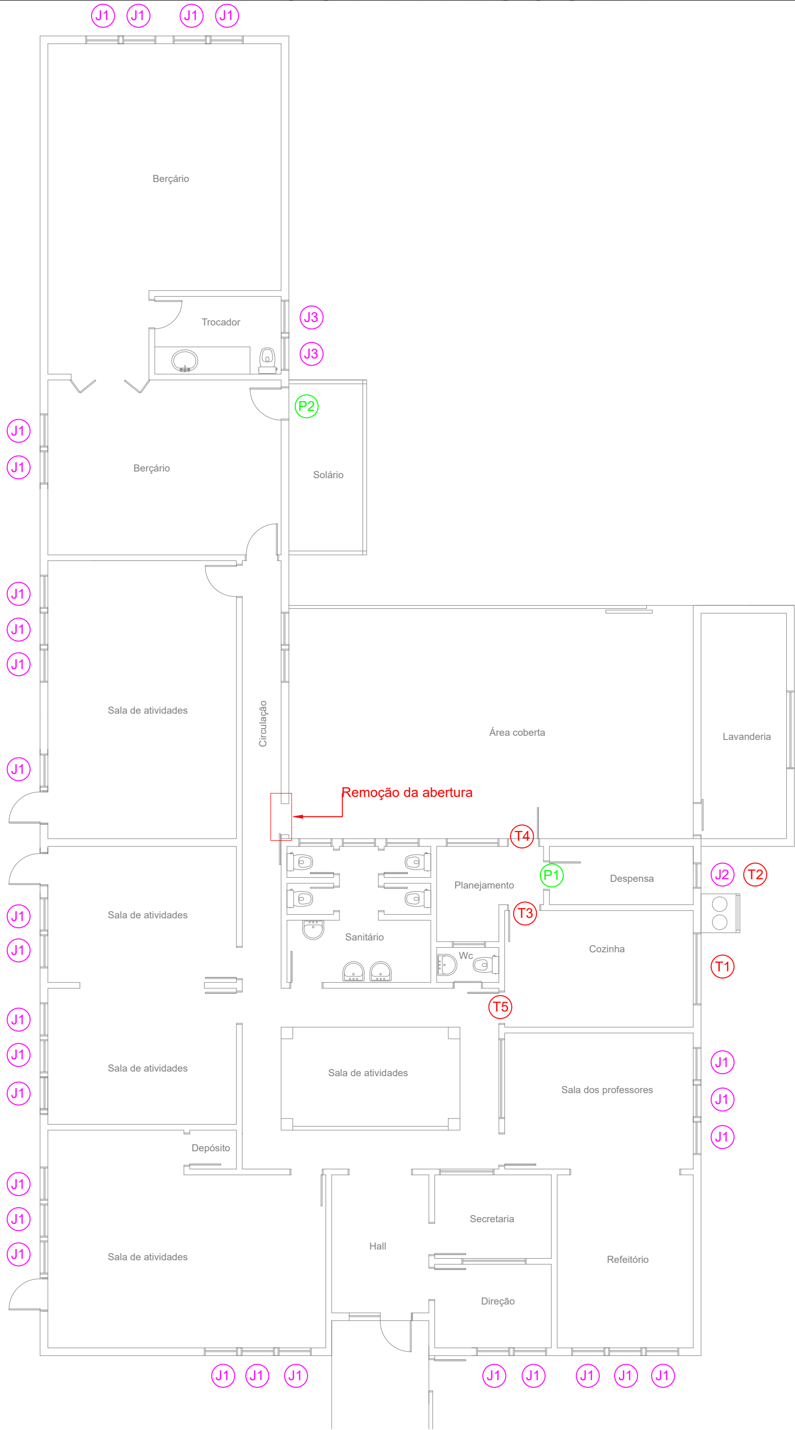
CROQUI PARA SUBSTITUIÇÃO DE ABERTURAS
