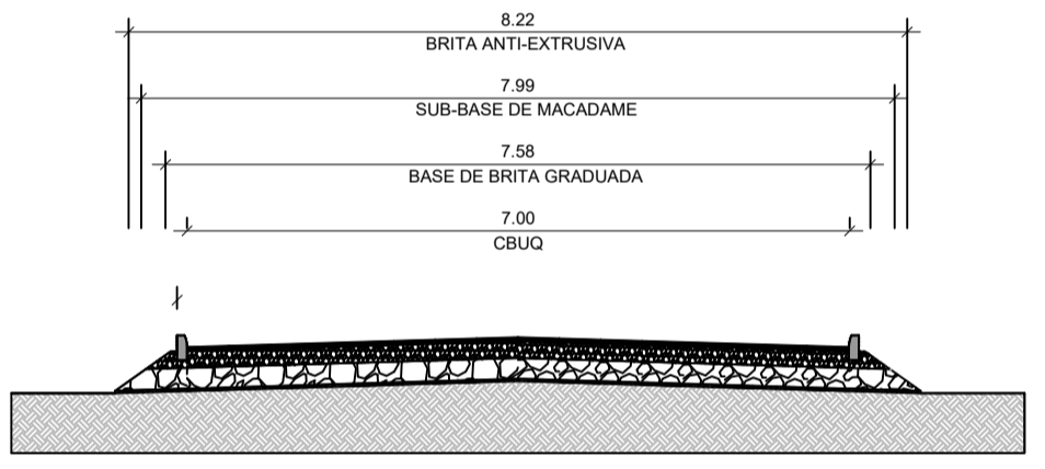
SEÇÃO TIPO DE PAVIMENTAÇÃO Sem escala
