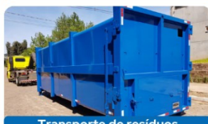
Transporte de resíduos em caçambas vedadas
